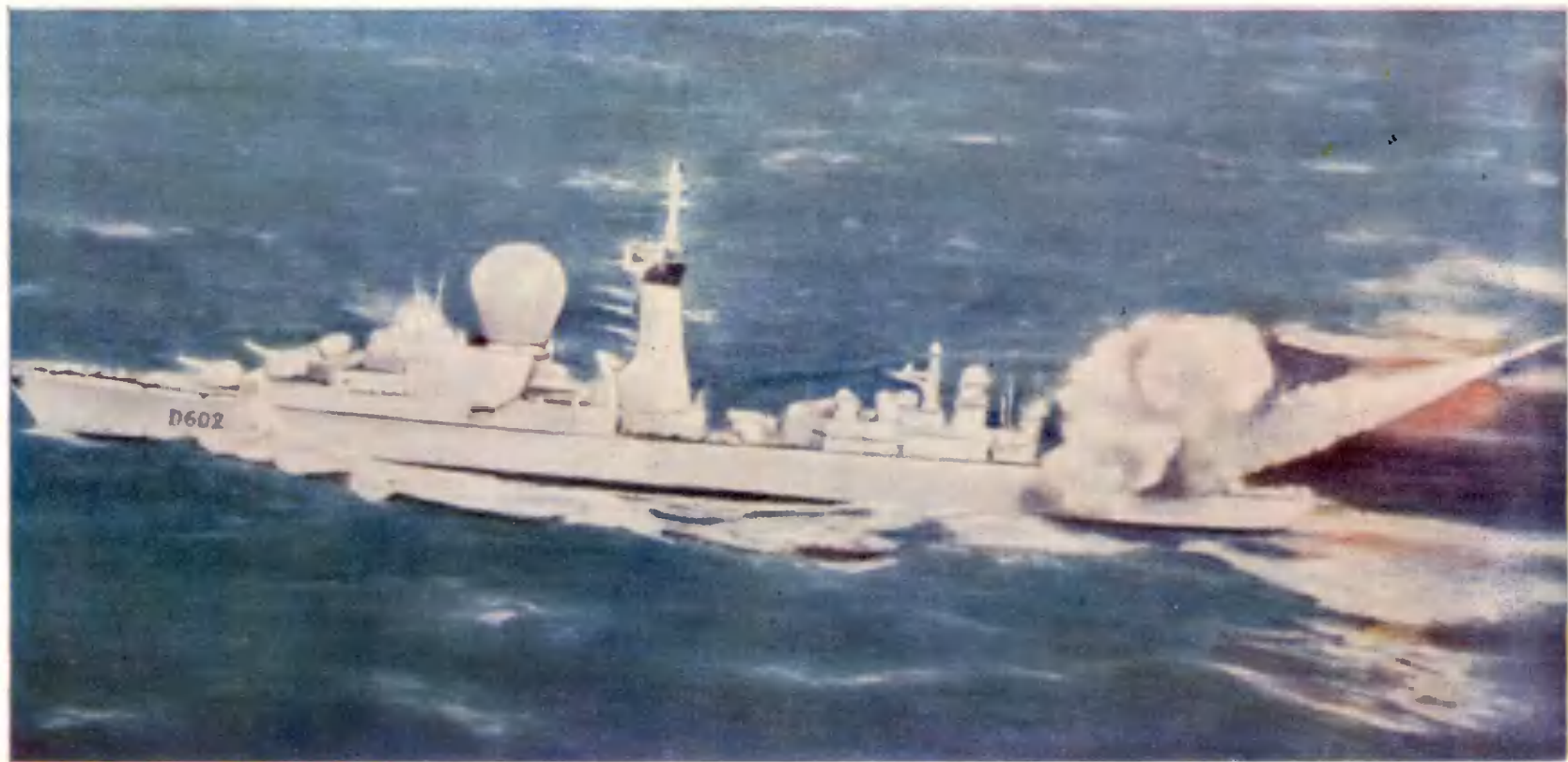
Французский фрегат УРО «Сюффрен». Водоизмещение стандартное 5090 т, полное 6090 т; длина 158 м, ширина 15,5 м, осадка 5,9 м; мощность энергетической установки 72 500 л. с; скорость хода 34 узла; дальность плавания при скорости 18 узлов 5000 миль; вооружение: система ЗУРО «Масурка» (спаренная пусковая установка), система ПЛУРО «Малафон», две универсальные 100-мм артиллерийские установки, два 30-мм автомата, четыре одитрурных торпедных аппарата для стрельбы противолодочными торпедами; экипаж 446 человек, из них 38 офицеров
