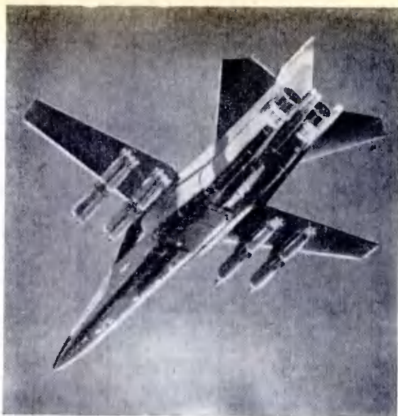
Рис. 2. Истребитель-бомбардировщик F-111A, вооруженный 16 бомбовыми кассетами CBU-42 (на подкрыльевых пилонах) и контейнером с аппаратурой РПД (под фюзеляжем)
